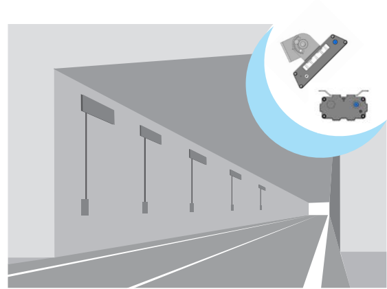
Beispiel einer Installation mit von der Leuchte getrennter GBOX
